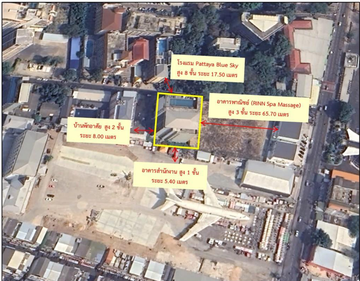
รูปที่ 4.1-2 ระยะทางจากแหล่งกำเนิดเสียงของโครงการไปยังแนวเขตที่ดินของผู้ที่ได้รับผลกระทบ
